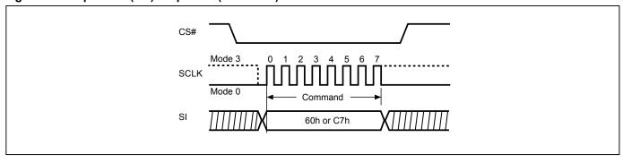
Figure 46. Chip Erase (CE) Sequence (QPI Mode)
