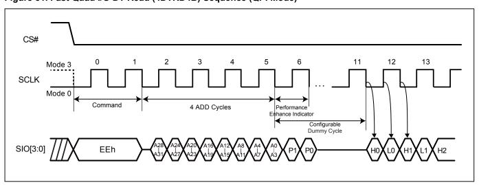
Figure 51. Fast Quad I/O DT Read (4DTRD4B) Sequence (QPI Mode)
