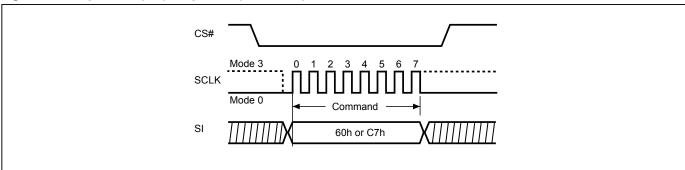
Figure 75. Chip Erase (CE) Sequence (QPI Mode)
